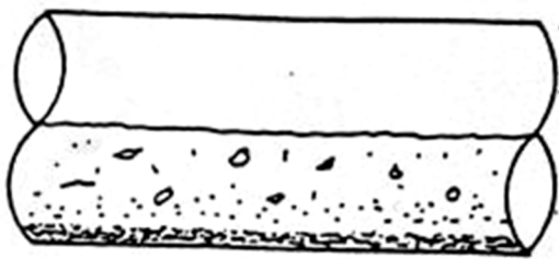
ب: در سرعت 1/4 تا 2 فوت بر ثانیه ذرات غیر آلی در ته لوله انباشته می شوند، تشکیل سولفید در این سرعت کم است.
