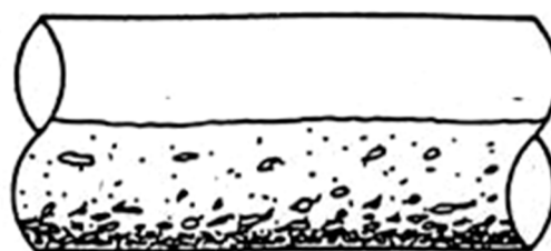
ج: در سرعت 1/4 تا 1 فوت بر ثانیه مواد غیر آلی ته نشین می شوند و مواد آلی به آرامی در ته لوله حرکت می کنند تولید سولفید هیدروژن افزایش یافته و در فاضلابروها مشکل ایجاد میکند.
