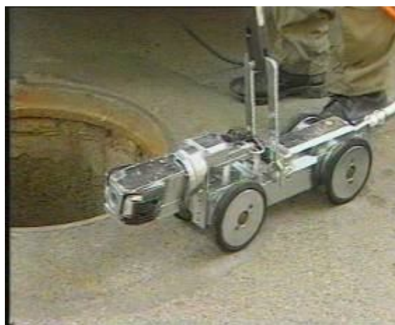
شکل ( ۲-۲۷) دوربین فیلمبرداری از داخل شبکه
